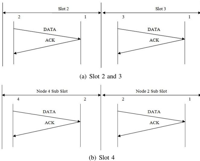
Fig. 4. TDMA Slot Details
